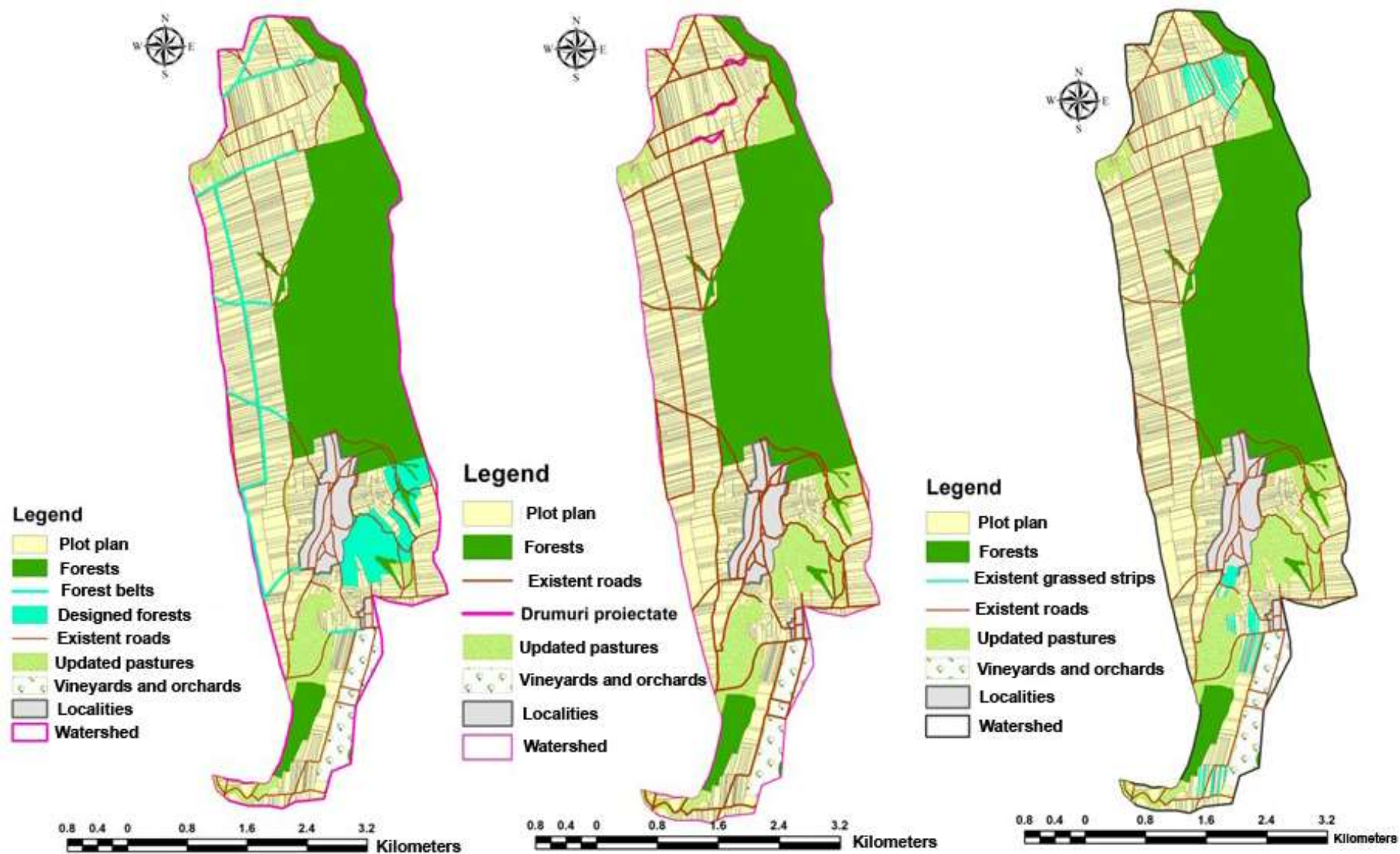
Figure 6. Actual and designed / provisioned landuse categories and anti-erosion works in Tomesti watershed.// Categoriile de folosinta a terenurilor actuale si proiectate/prevazute si lucrari antierozivne in bazinul hidrografic Tomesti
